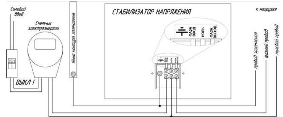
Рисунок 2. Рекомендуемая схема подключения стабилизатора к сети.
